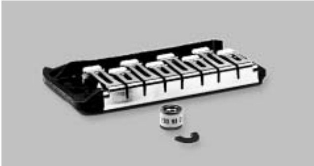
Магазин первичной защиты для кроссового оборудования HVt 71 (на 4 пары), оснащенный разрядниками и элементами термозащиты разрядников
