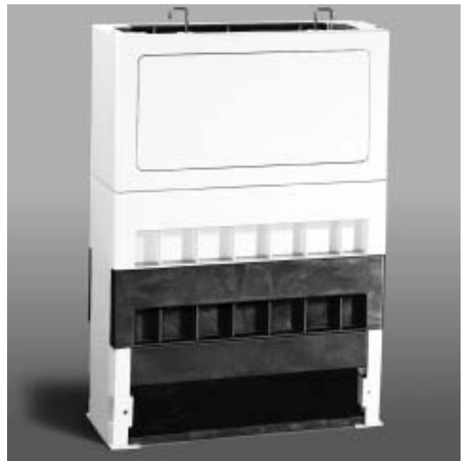
Цоколь типа 1060 «Комфорт» с закрытой фронтальной крышкой. Фронтальная крышка заказывается отдельно.
